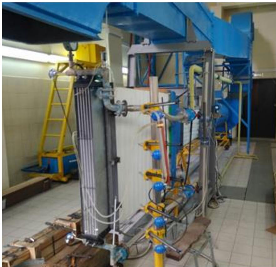
**Рисунок 30 – Стенд испытаний секций радиаторов различных серий установленный в лаборатории в г. Щербинке АО «ВНИИЖТ»**
