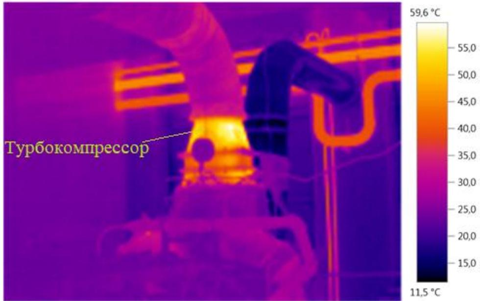
**Рисунок 34 – Термограмма распределения температур при прогреве дизельного двигателя 21-2ДГ (температура воды 24 °С)**
