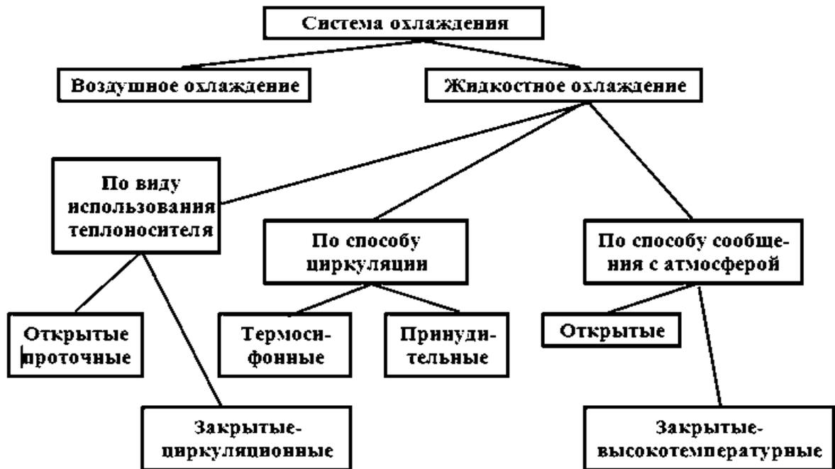
Рисунок 1 – Упрощенная классификация систем охлаждения ДВС
